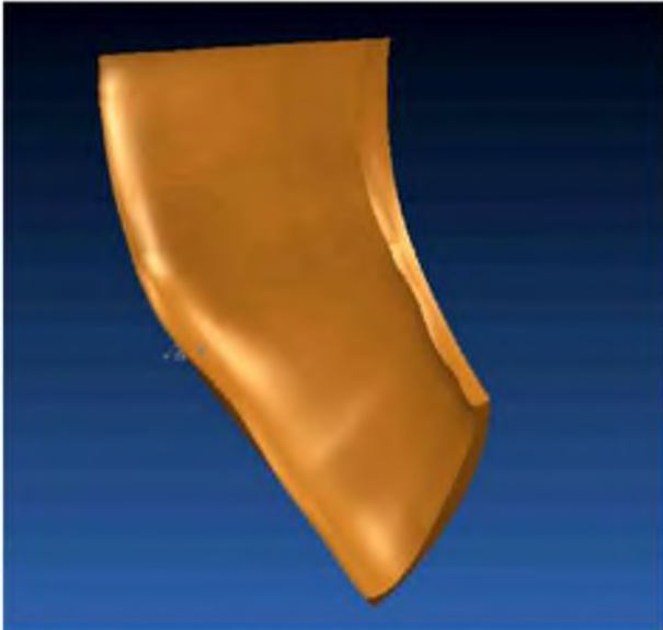
Рис. 4. Пластина шаблону (внутрішня поверхня відповідає зовнішній поверхні нижньої щелепи та лицевій поверхні резекційного імплантата)
