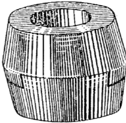
Рис. 24. Кювета для полімеризації пластмасової коронки
