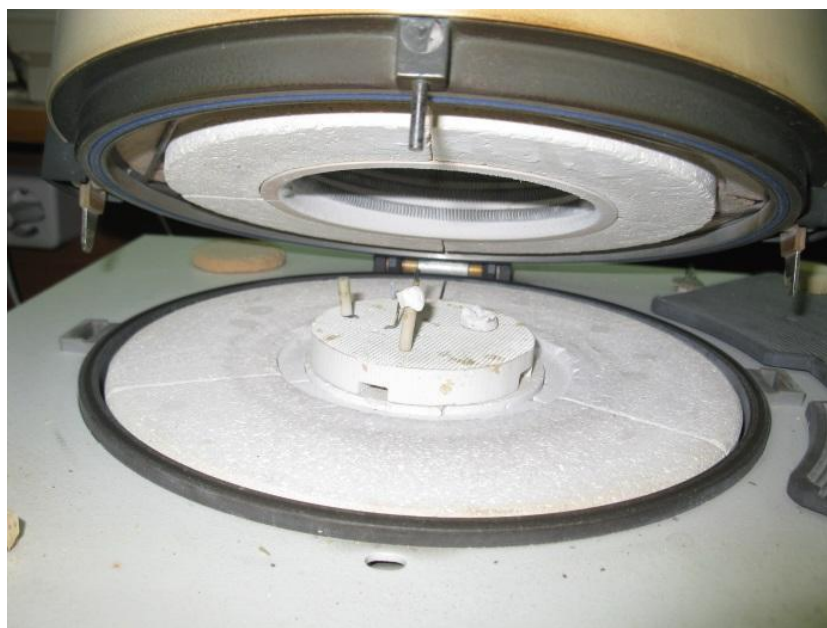
Рис. 78. Каркас покритий опакон після обпалу в печі
