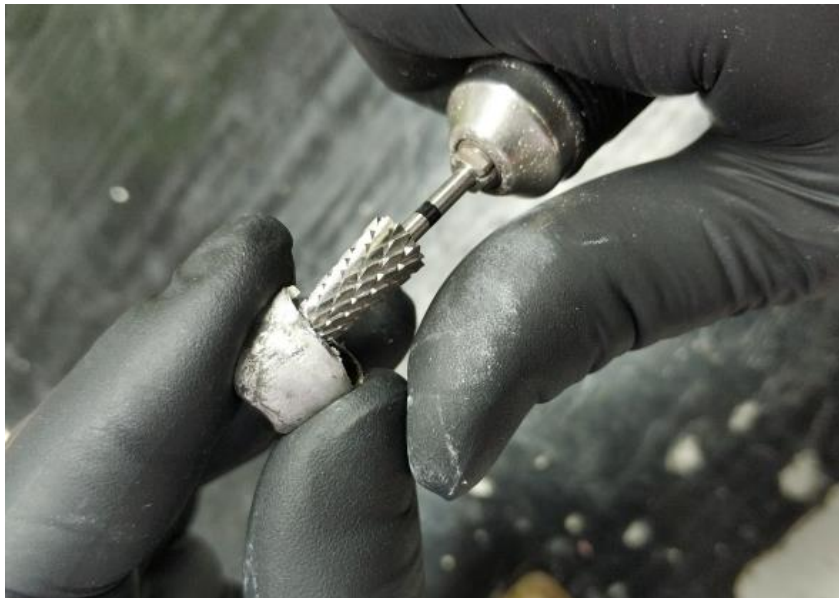
Рис. 52. Механічна обробка краю штампованої коронки.
