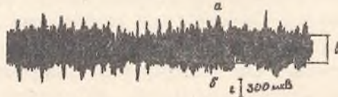
Мал.6. Схема визначення сумарної амплітуди ЕМГ: а, б - горизонтальні лінії, які проходять по вершинах найчастіше повторюючихся амплітуд; а - сумарна амплітуда ЕМГ; г - калібровочний сигнал
