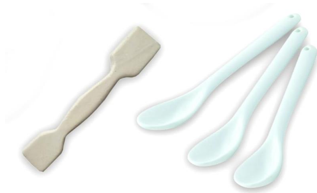
шпателі та порцелянові ложки (використовують для відбирання твердих речовин).
