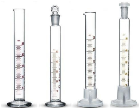
мірні циліндри (використовують для відмірювання рідин з невеликою точністю)
