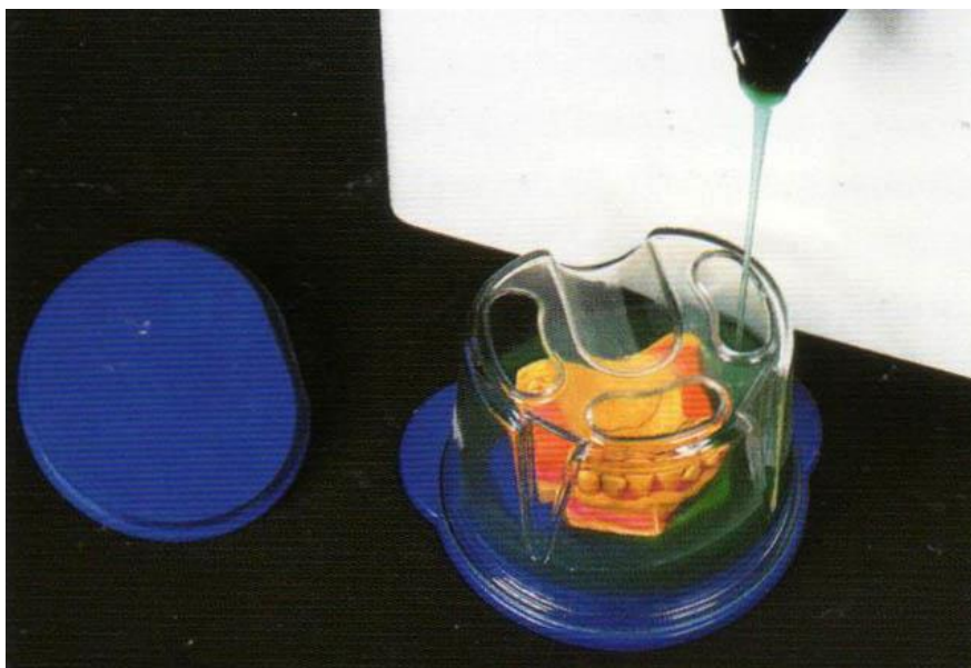
Рис. 143. Процес заливки дублюючої маси у кювету
