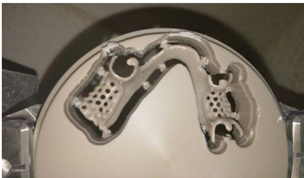
Рис. 185. Приклад фрезерування каркасу бюгельного протеза зі стандартного акрилкетонного полімерного (АКР) блоку
