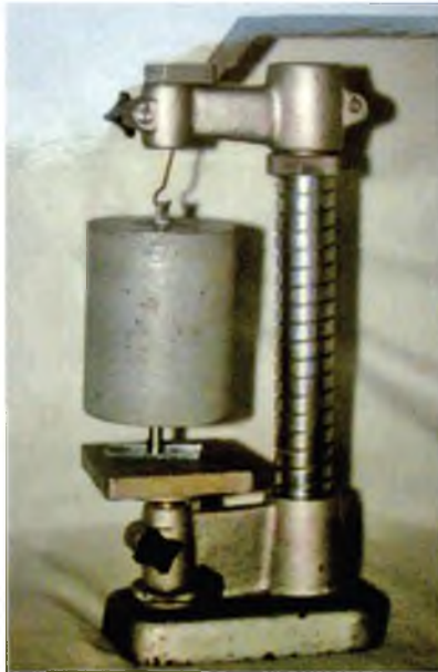
Рис. 15. Навантажувальний пристрій для визначення товщини цементної півки.
