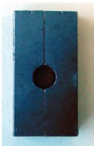
Рис. 16. Металева форма для виготовлення дослідних зразків при визначенні водопоглинання та дезінтеграції цементів.
