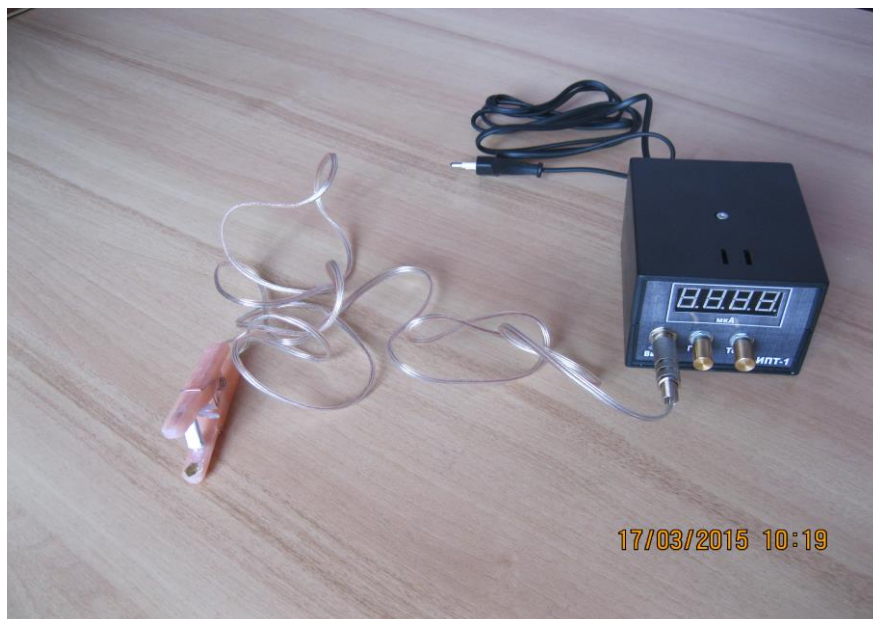
Мал.1. Загальний вид пристрою для визначення чутливості смакових рецепторів язика
