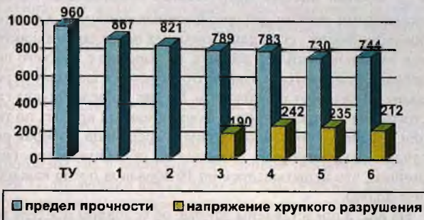
Рис. 4. Предел прочности и напряжение хрупкого разрушения сплава Remanium GM 700 при последовательных переплавах. ТУ - предел прочности сплава согласно паспорта; 1, 2, 3, 4, 5, 6 - количество переплавов
