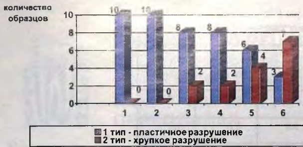
Рис. 2. Распределение образцов по типам разрушения при последовательных переплавах сплава Remanium GM 700. 1, 2, 3, 4, 5, 6 - количество переплавов.
