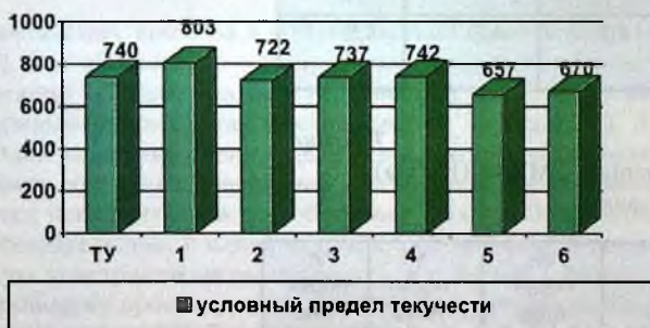
Рис. 3. Условный предел текучести сплава Remanium GM 700 при последовательных переплавах. ТУ - предел текучести сплава согласно паспорта; 1, 2, 3, 4, 5, 6 - количество переплавов.
