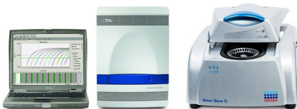
Рис. 18. Ампліфікатори для ПЛР у режимі реального часу.
