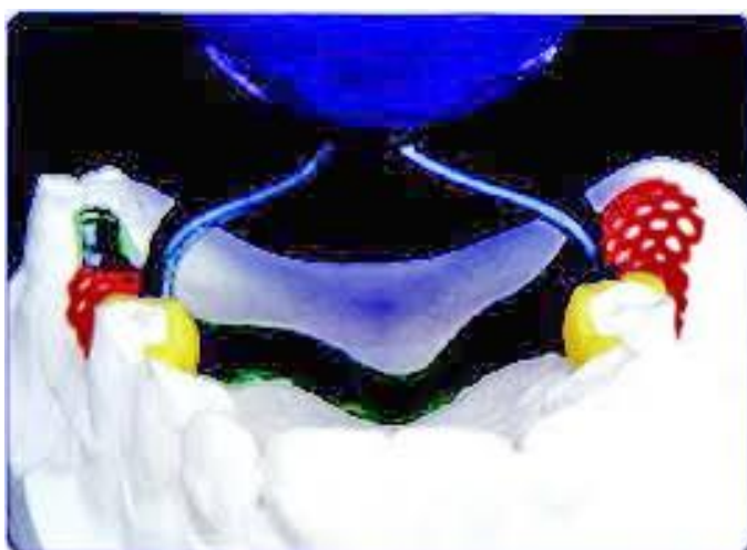
Мал. 28 Приклад побудови ливникових каналів при литті каркаса бюгельного протеза на верхню щелепу
