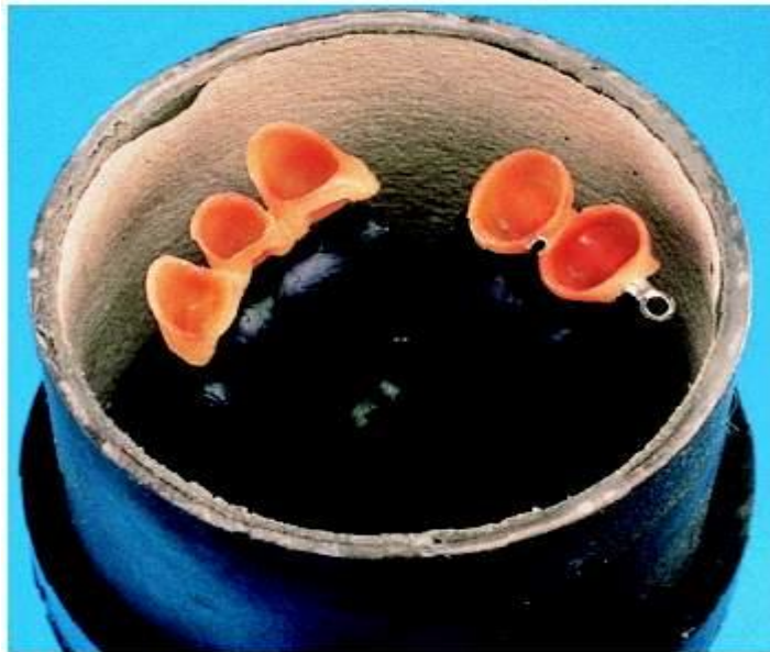
Мал. 29 Правильне положення форми в зібраному вигляді при відцентровому литті
