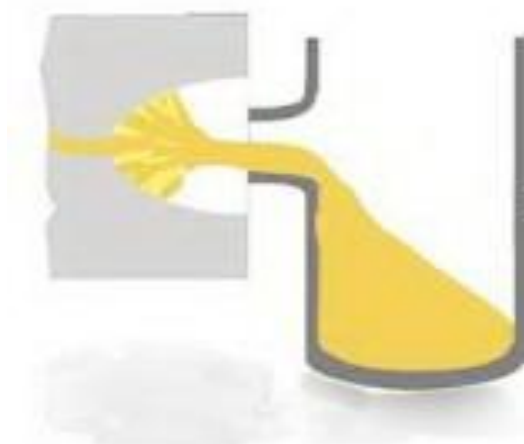
Мал. 18 Шлях потрапляння розплаву в ливниковий канал
