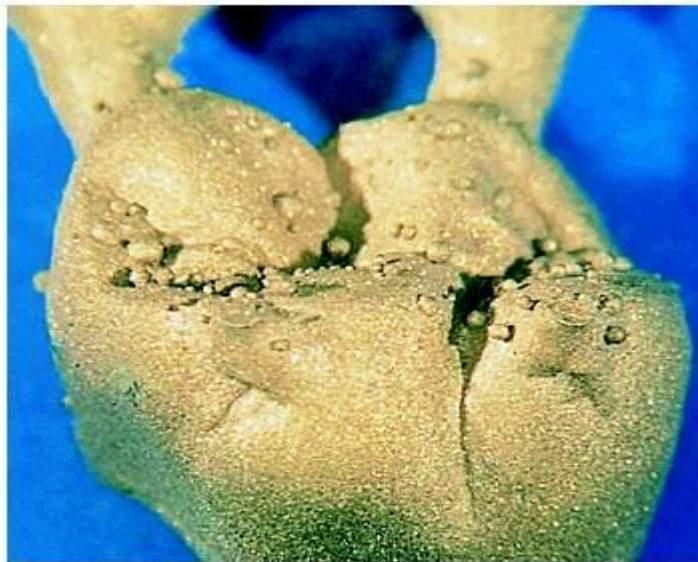
Мал. 37 Невеликі кульки на литві. Пакувальна маса була замішана без вакууму
