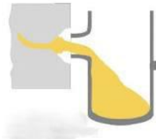
Мал.17 Заповнення розплавом ливникової лійки
