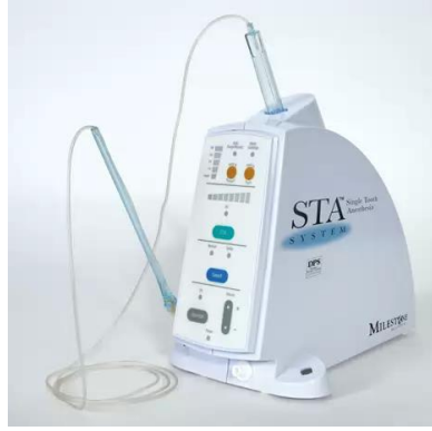
Рис.16. Система STA за допомогою технології динамічного контролю за тиском дозволяє постійно контролювати процедуру проведення карпульної місцевої анестезії
